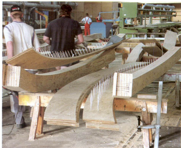
Dreidimensional gefräste Kerto-Teile – verleimt.
